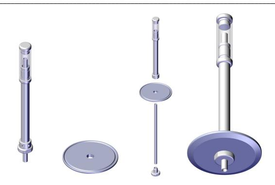
2. На готовый узел устанавливаются 3 трехдюймовых диоптра. Объем колонны Сокслета в сборке составляет примерно 900 мл. В диоптры загружается навеска сырья для экстракции. Затем колонна с навеской крепится к паропроводу. Нижняя часть экстрактора соединяется силиконовым шлангом с переливной штуцер "елочкой" на нижней части паропровода.
