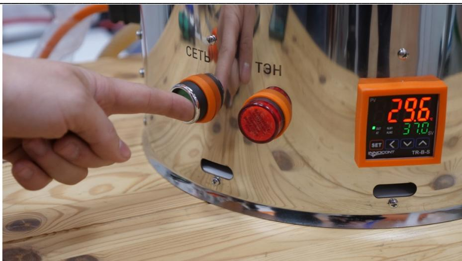
Клапан на подачу воды оснащен датчиком протока жидкости и в случае отсутствия воды в сети или закрытом кране подачи воды, установка автоматически отключится.
