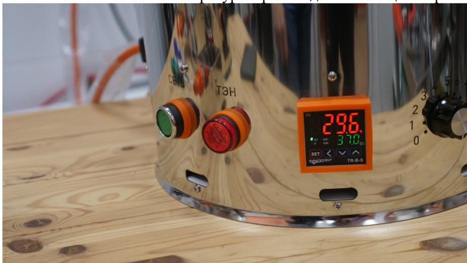
7. После того, как установлена необходимая температура отключения и выставлена рабочая мощность ТЭНа, отжимаем кнопку Сеть. Далее установка работает в автоматическом режиме.
