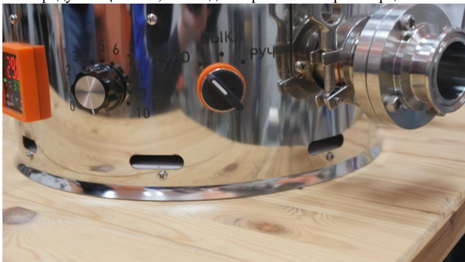
6. На термоконтроллере задается температура, при которой установка должна отключиться. Уставка температуры происходит с помощью стрелок вверх/вниз.
