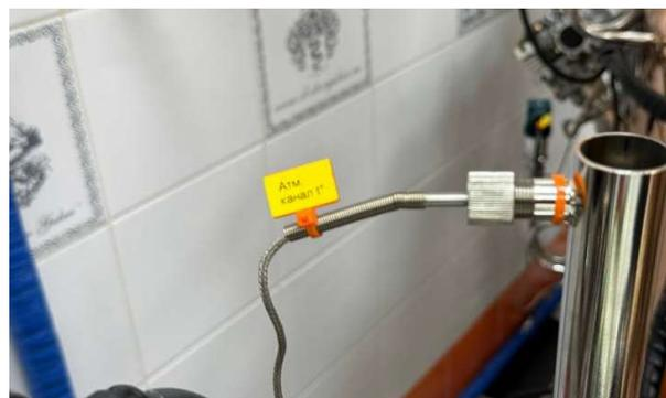
Устанавливаем датчики голов и хвостов.
