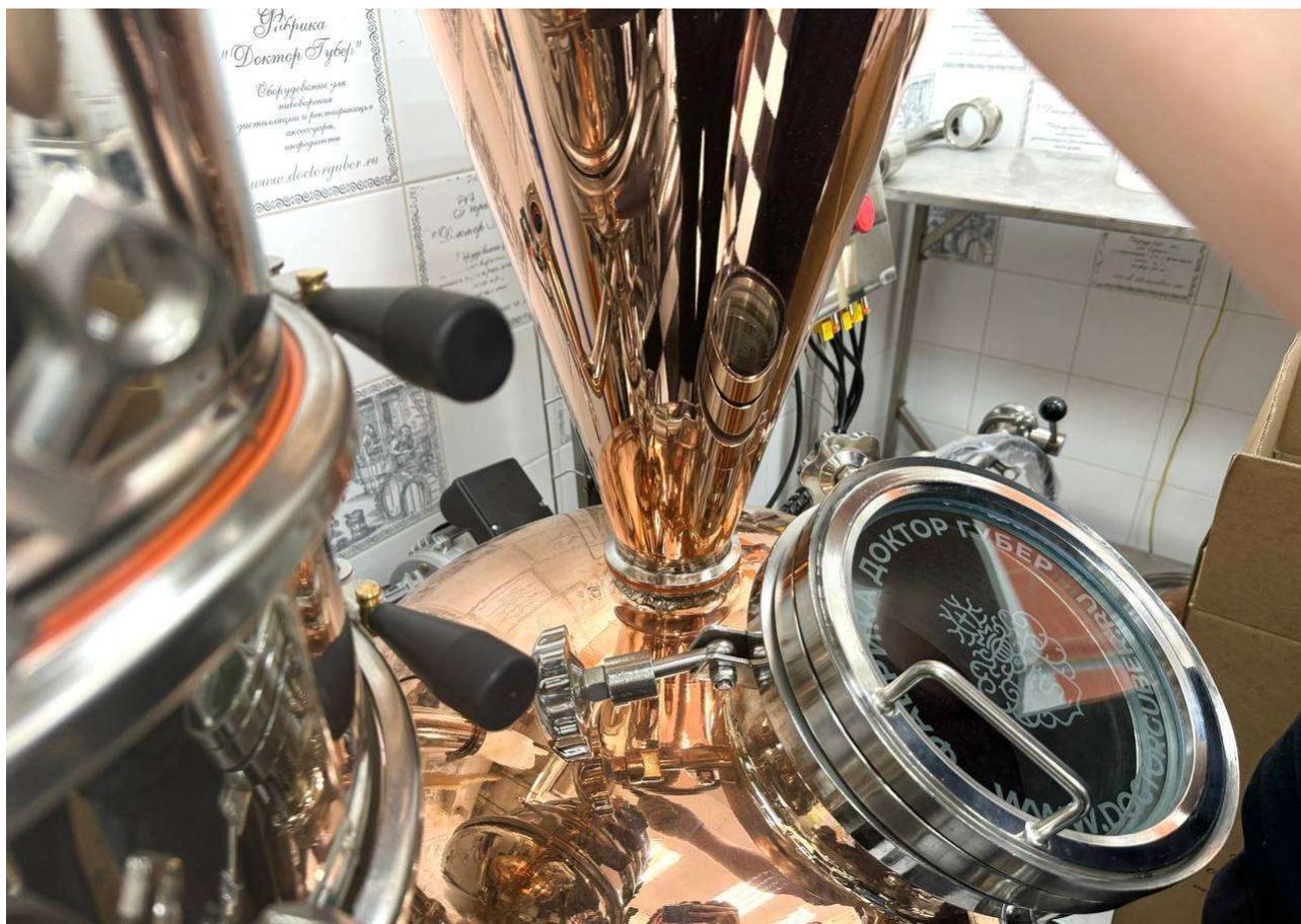
Теперь закрепляем медный шлем при помощи хомута.
