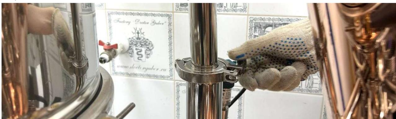
Здесь важно следить за тем, чтобы в области креплений при помощи хомутов высота между составляющими совпадала, и не возникало сложностей с соединением частей между собой. Поэтому регулируем паровые магистрали по высоте уже в процессе сборки.
