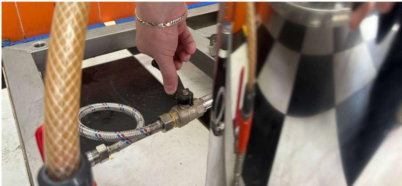
Заполнения рубашки отслеживаем по уровню в диоптре. Диоптр должен быть заполнен водой минимум на половину.
