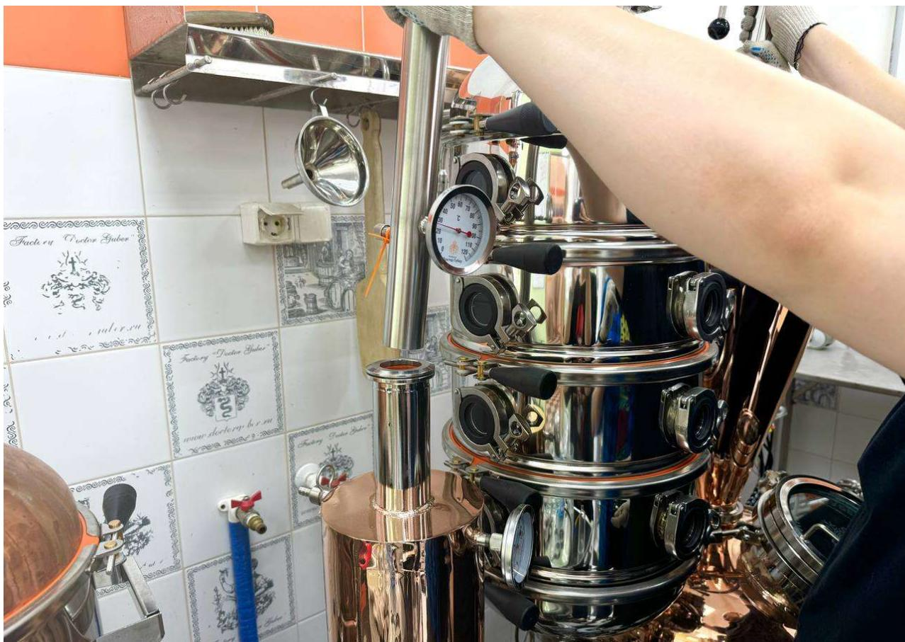
Проверяем наличие прокладки и закрепляем хомутами!
