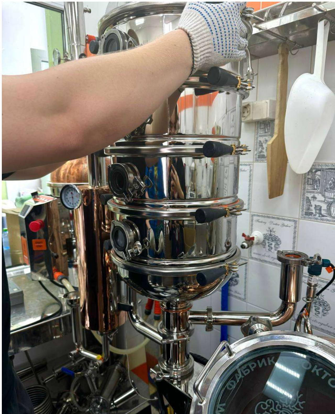
Закрепляем тарельчатую колонну хомутами, которые поставляются в комплекте.
