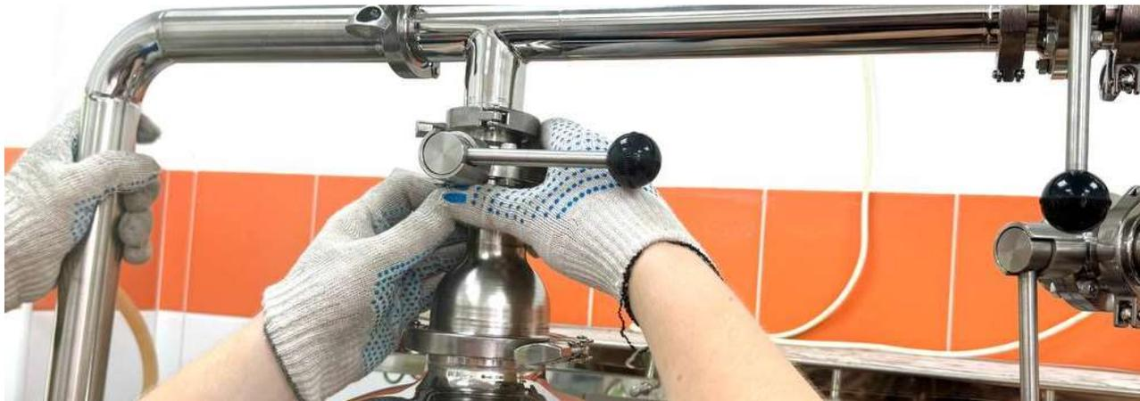
Прикрепляем П-образную паровую магистраль к медному доохладителю, тарельчатой колонне и медному шлему. Г-образную паровую магистраль прикрепляем к **выводу** тарельчатой колонны и выводу из медного шлема.
