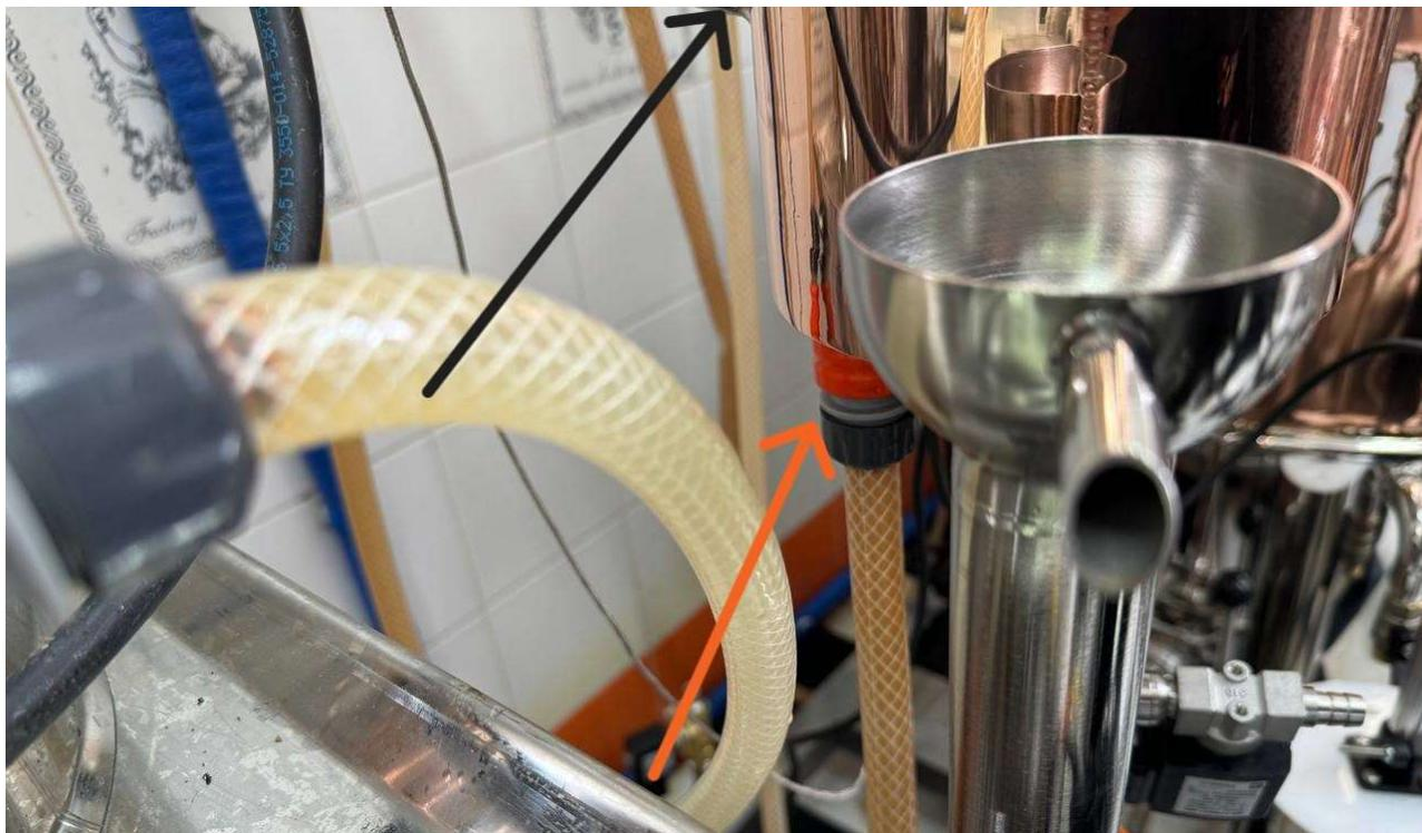
Кран подачи воды из рамы аппарата «Симпл» в пароводяную рубашку котла на 130 литров.
