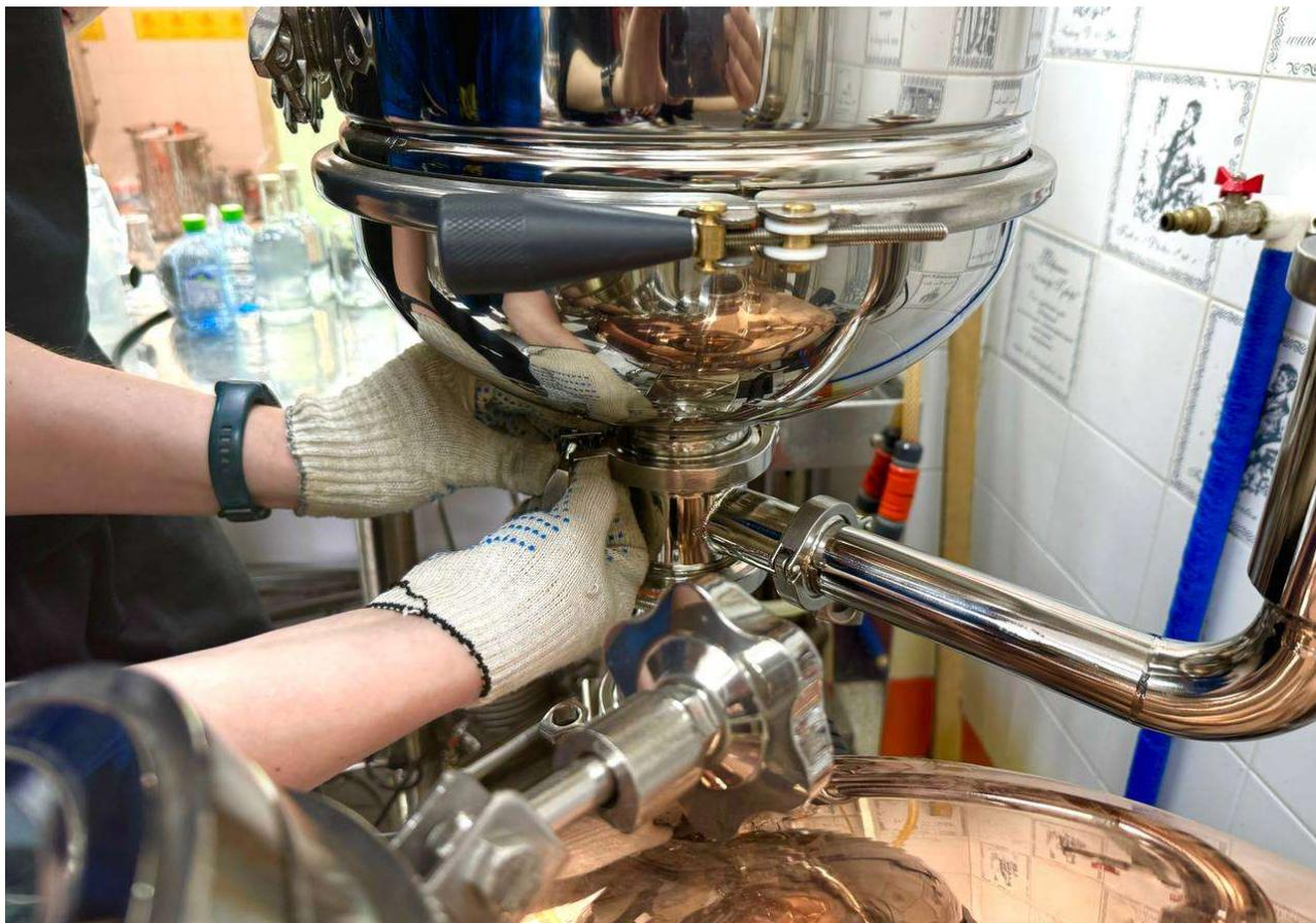
Следующим действием будет установка медного шлема на ПВК. Точно так же проверяем, чтобы силиконовая прокладка была на своем месте.
