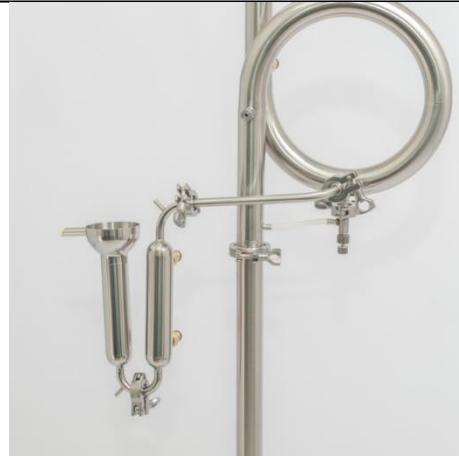
5. Особое внимание уделите гильзе для установки термометра. Гильза состоит из 3 съемных элементов: втулка, прокладка, колпачок.
