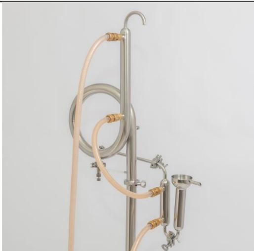
*холодильника будет горячим. Температура на его поверхности может достигать 80 градусов. Нужно быть аккуратными и соблюдать правила безопасности. Контроль за эффективностью охлаждения осуществляется с помощью замера температуры охлаждающей жидкости на выходе (сливном канале). Разница между температурой на входе и выходе должна составлять от 10-30 градусов Цельсия.*
