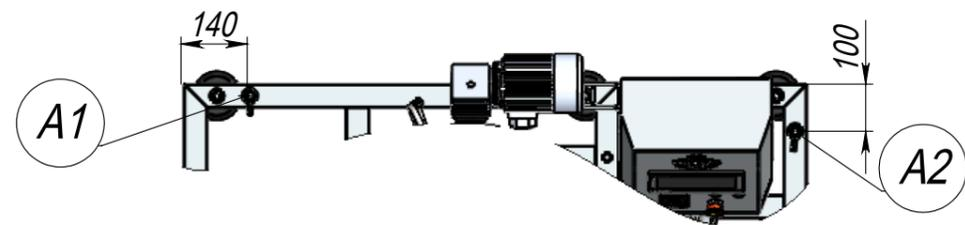
A1, A2\* - подключение охлаждающей воды, G 1/2
