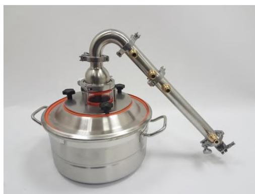
8. Устанавливаем термометры в ниппель на фланце и ниппель в отводе. Перед установкой термометра ниппель слегка откручивается, затем вставляется термометр и ниппель закручивается.
