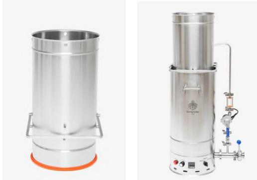
3. При необходимости или недостаточном осветлении стекаемое сусло с помощью экстрактора можно вернуть в корзину для повторного осветления
