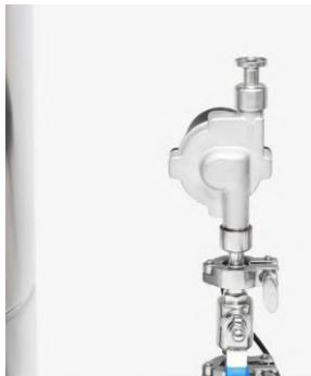
5. На помпу крепится диоптр для визуального контроля за процессом затирания и процессом осветления сусла
