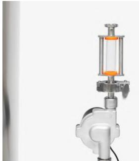
6. На диоптр монтируется отвод с силиконовым шлангом и рассекателем
