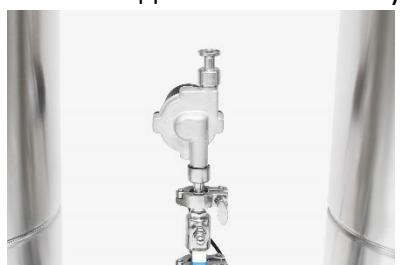
7. На насос устанавливается смотровой диоптр для визуального контроля за процессом работы экстрактора.
