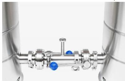
5. На тройник устанавливается шаровый нержавеющий кран для регулировки скорости прокачки сусла.
