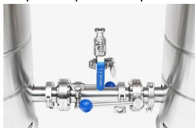
6. На кран монтируется насос, стрелкой по направлению перекачиваемой жидкости. Помпа подключается к котлу, в котором будет проходить затирание .
