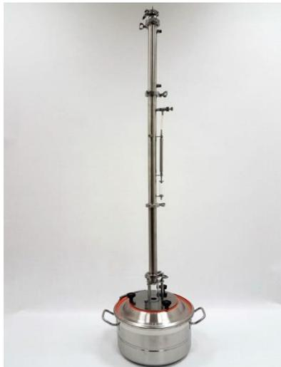
6. Термометры монтируются в ниппель на фланце и ниппель узла отбора. Перед установкой термометра ниппель слегка откручивается, затем вставляется термометр и ниппель закручивается.
