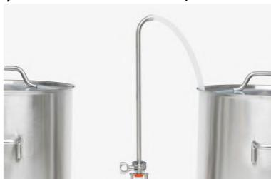
2. С помощью кнопки на блоке питания включается помпа, краном регулируется скорость откачки сусла в котел.
