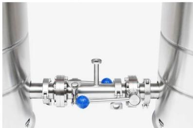
5. На тройник устанавливается шаровый нержавеющий кран для регулировки скорости прокачки сусла.
