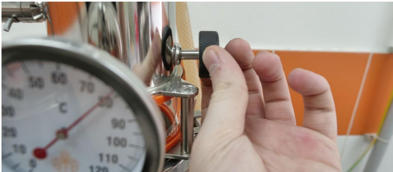
Рекомендованная скорость (все замеры были сделаны при перегонке спирта-сырца крепостью 40% при работе на котле 45 литров, подводимая мощность 2,7кВт):
