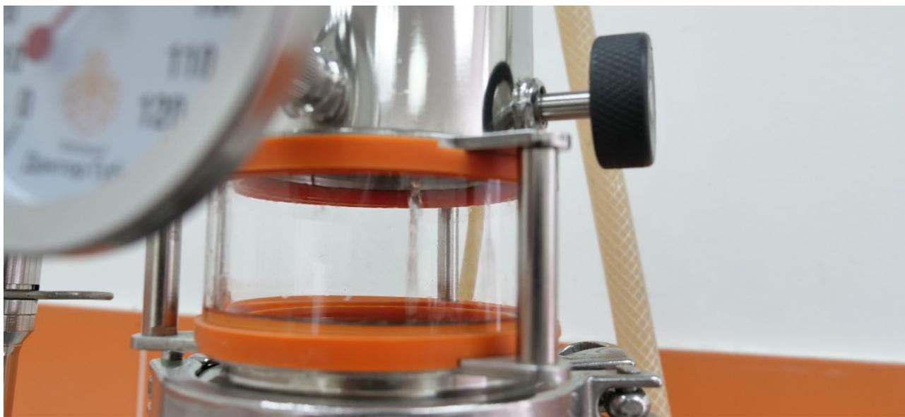
5. Настроить поток охлаждающей жидкости по верхнему термометру. Температура охлаждающей жидкости на выходе должна быть в диапазоне от 20 до 40 градусов Цельсия.
