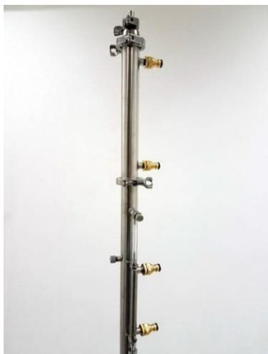
8. Устанавливаем термометры в ниппель на фланце и узле отбора. Перед установкой термометра ниппель слегка откручивается, затем вставляется термометр и ниппель закручивается
