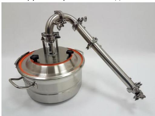
6. К холодильнику подключаем шланги последовательно снизу вверх.
