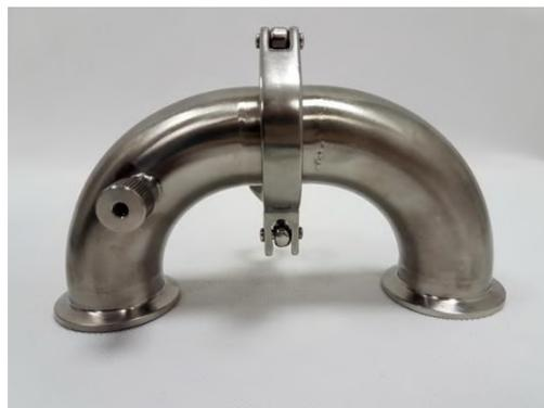
Полученный отвод устанавливаем на мини-дефлегматор таким образом, чтобы ниппель был над удлинителем
