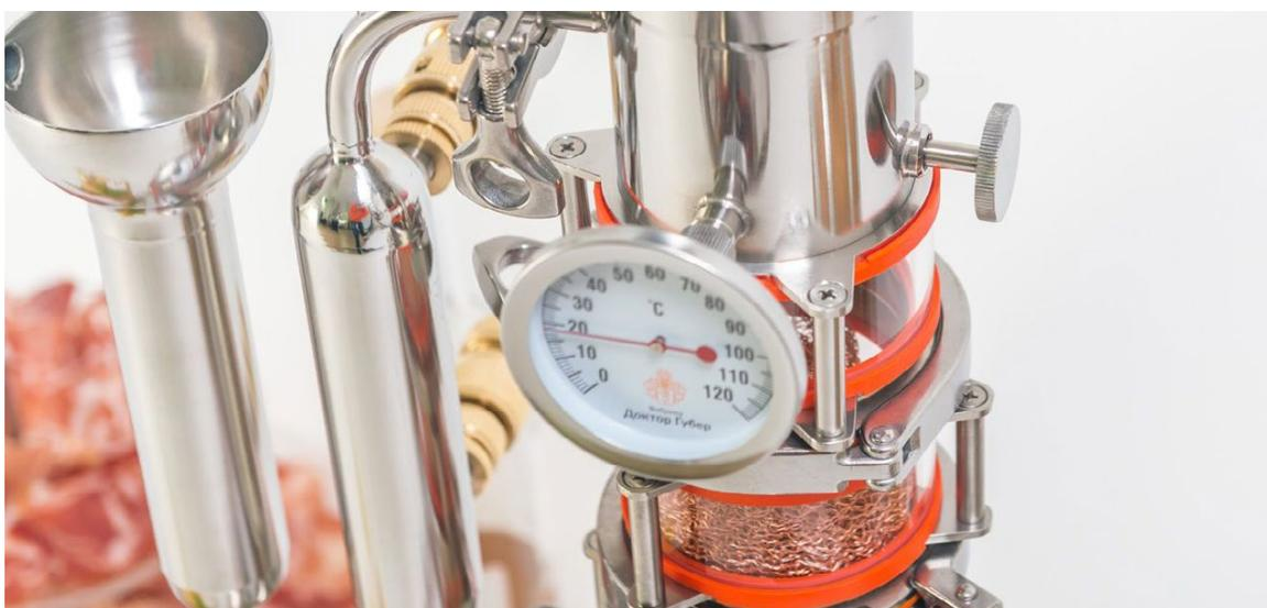
Температура в колонне при работе с аппаратами Доктор Губер типа “Миджет” носит символический характер, так как контроль готового продукта ведётся по крепости в стакане непрерывного измерения. Данный термометр нужен больше для красоты.
