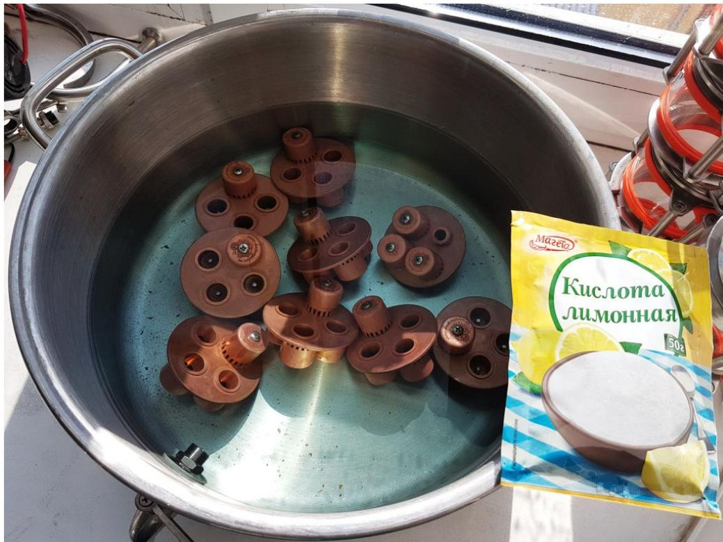
В результате химической реакции кислота разрушит образовавшийся налет солей и тем самым проведет очистку поверхности деталей. После чего медные детали необходимо извлечь из раствора и для удаления остатков солей протереть обычной губкой.
